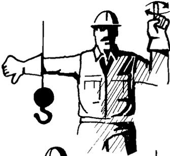
**LOWER THE BOOM AND LOWER THE LOAD**
